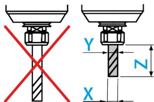
**Le diamètre de coupe de l'outil (X) ne doit pas être supérieur à la plage de serrage maximale (Y).**
